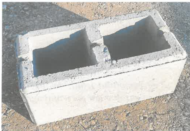
Foto nr. 1 – Imagine blochet din beton cu conținut de material reciclat
