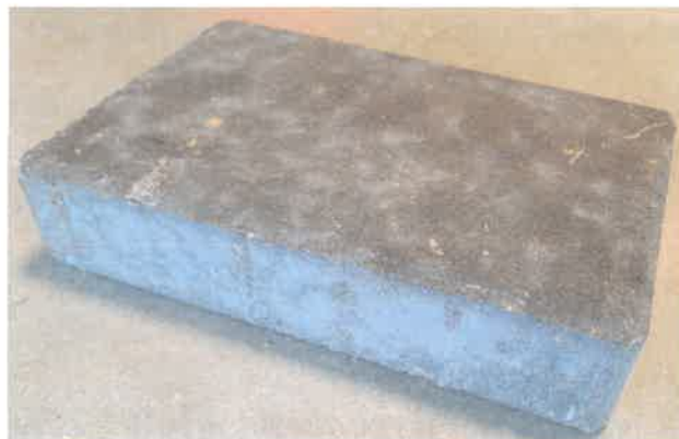
Figura nr. 1 – Pavelă din beton cu conținut de material granular reciclat
